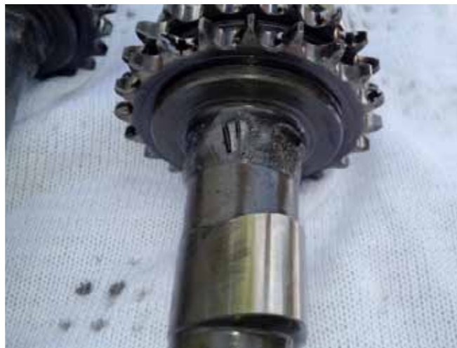
Uitlaat nokkenas 2.7 carburateur Lift is 8,70 mm Merktteken is twee keer een I, wat versprongen ten opzichte van elkaar
