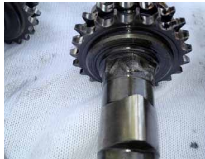
Inlaat nokkenas 2.7 carburateur Lift is 8,95 mm Merktteken is een V
