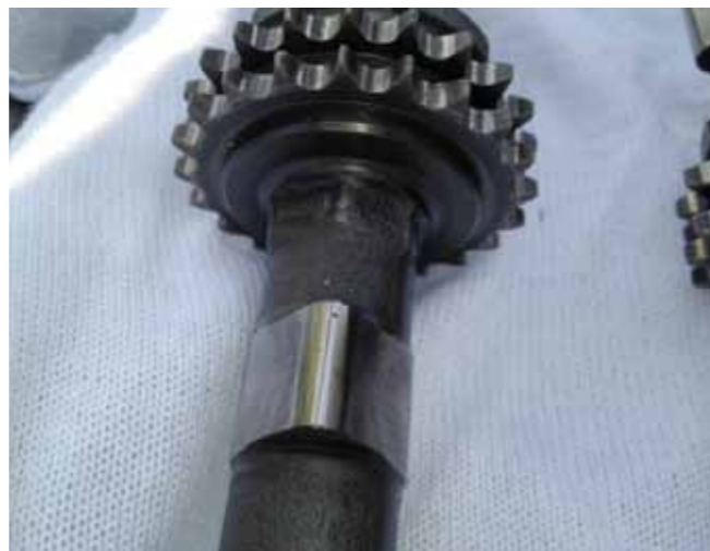
Uitlaat nokkenas 2.7 carburateur Lift is 8,70 mm Merktteken is twee keer een I, wat versprongen ten opzichte van elkaar
