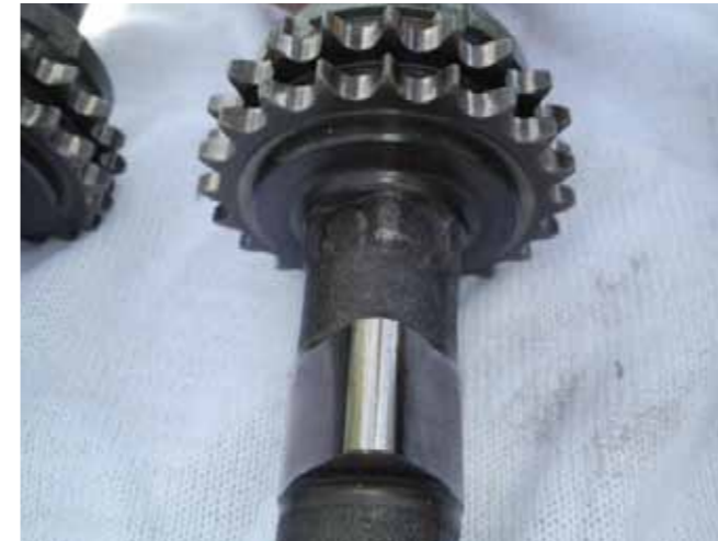
Uitlaat nokkenas 2.7 injectie / 3.0 carburateur Lift is 10,10 mm Merktteken is een liggend streepje of Romeinse I
