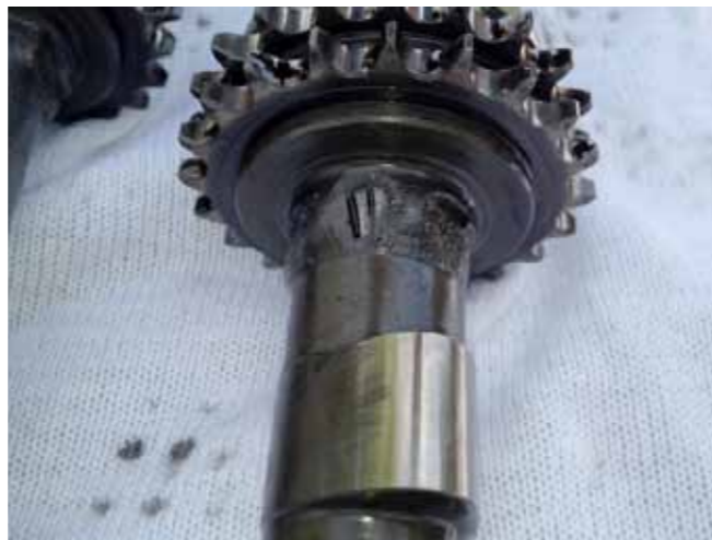
Uitlaat nokkenas 2.7 carburateur Lift is 8,70 mm Merktteken is twee keer een I, wat versprongen ten opzichte van elkaar
