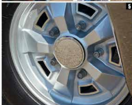
1 Maserati V6 onder de motorkap. 2 Het kenmerkende rooster in de motorkap, voor voldoende luchttoevoer voor de verwarming. 3 Combi-instrument met waarschuwingslampjes. 4 Meedraaiende koplampen. 5 Een van de RR-wielen (afkorting van Roues Résine), van een kunstharzlegering.
